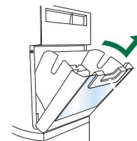
**REMARQUE :** Il n'est pas nécessaire de tourner le commutateur On/Off (marche/arrêt) de la machine à glaçons à la position OFF (arrêt) (vers le bas) lors du retrait du bac d'entreposage. Le détecteur du bac d'entreposage sur la paroi de gauche de la porte du congélateur interrompt la production de glaçons lorsque la porte est ouverte ou que le bac d'entreposage a été enlevé.
